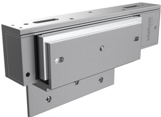
A fechadura-eletroímã com tração de 300 kgf foi desenvolvida para ser utilizada em portas de madeira, alumínio ou aço com abertura para dentro ou para fora. Fácil de instalar, é compatível com controladores de acesso, interfones e fontes com saída temporizada para abertura de portas. A fechadura FE10300, possui os seguintes certificados: RoHS – BST16074619A0007RC-4; CE – BCTC-160301980C; FCC – BST16074619A0007EC-3.
