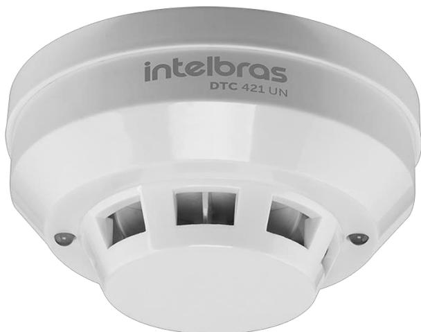
El sensor de temperatura se dispara cuando hay variación rápida de la temperatura (termovelocimétrico) o cuando la temperatura alcanza 60 °C (± 5 °C). Al detectar la temperatura, el sensor se comunica con el panel de alarma.
