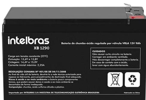
A XB 1290 é uma bateria de chumbo-ácido regulada por válvula selada VRLA recarregável, livre de manutenção e protegida contra vazamento. Uma bateria para uso geral, com vida útil de até 5 anos em regime de flutuação, indicada para aplicação em sistemas de segurança e nobreaks (UPS).
