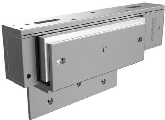
A fechadura-eletroímã com tração de 600 kgf foi desenvolvida para ser utilizada em portas de madeira, alumínio ou aço com abertura para dentro ou para fora. Fácil de instalar, é compatível com controladores de acesso, interfones e fontes com saída temporizada para abertura de portas.
